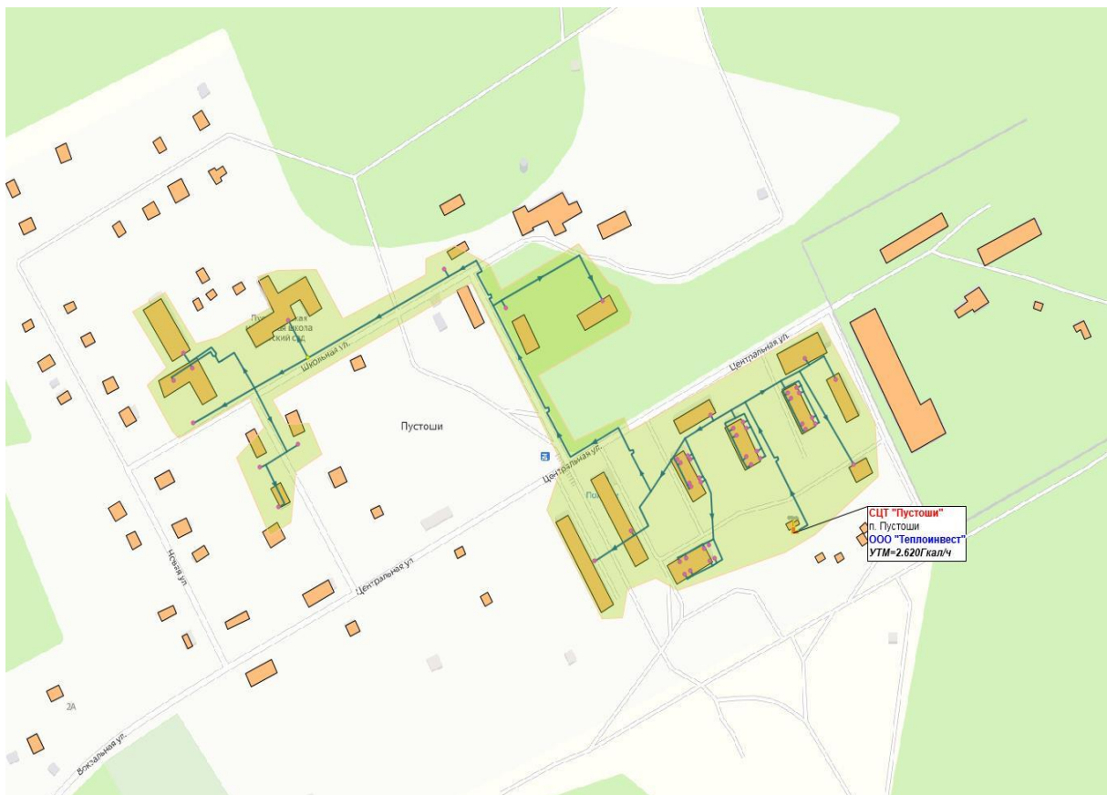
Рисунок 2.1-33 Зона деятельности котельной «Пустоши» ООО «Теплоинвест»
